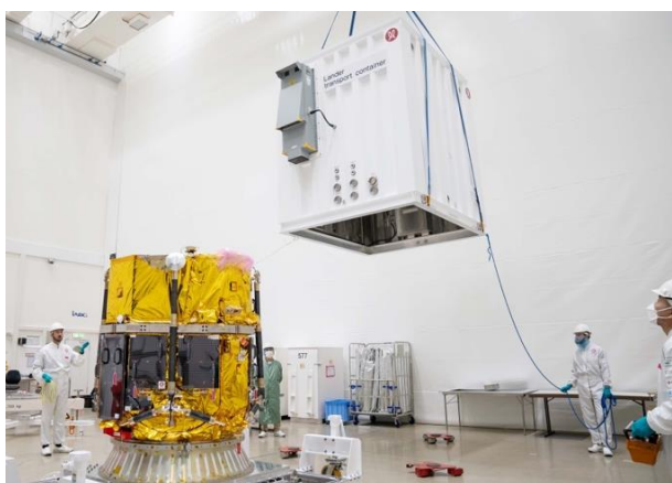
ランダーを専用の輸送コンテナに格納する様子（IABG 宇宙試験施設） コンテナを輸送機に積む様子（ミュンヘン空港）
